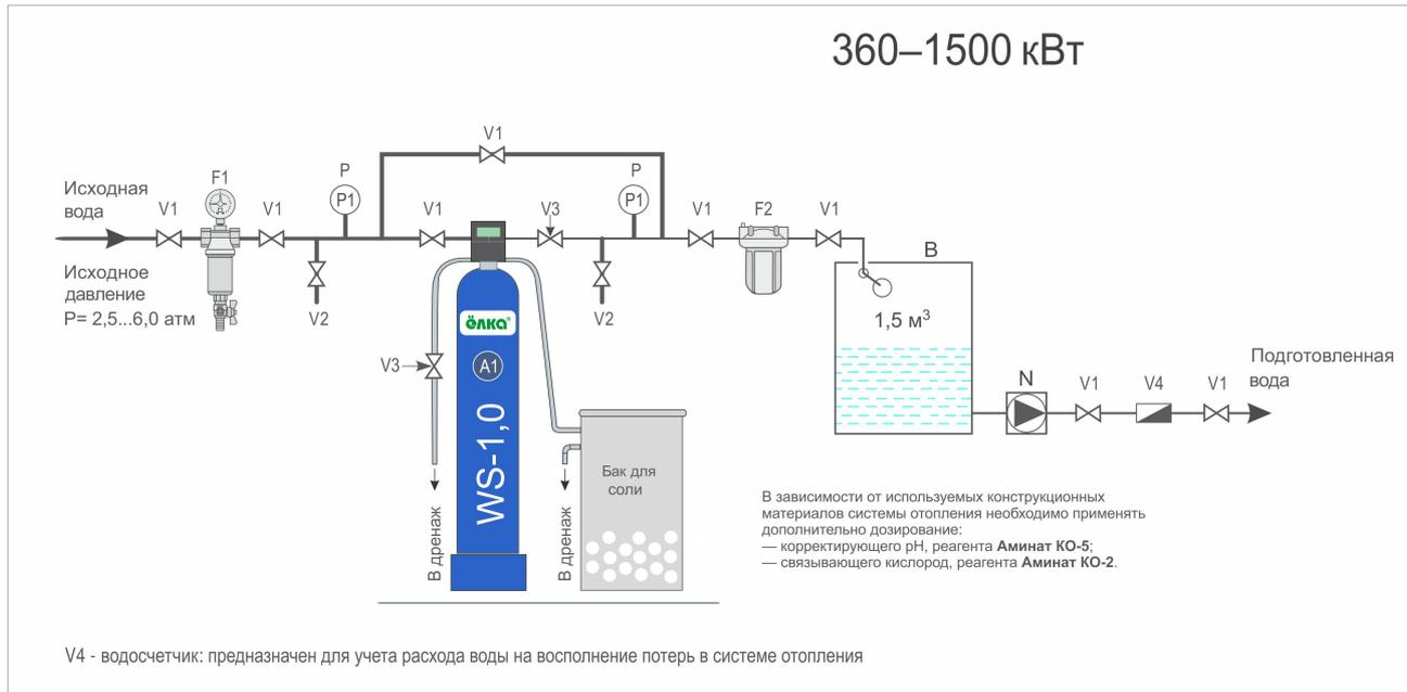
A1 — арт. 04010337 Установка умягчения периодического действия Ёлка. WS-1,0-Rx-(SC)
